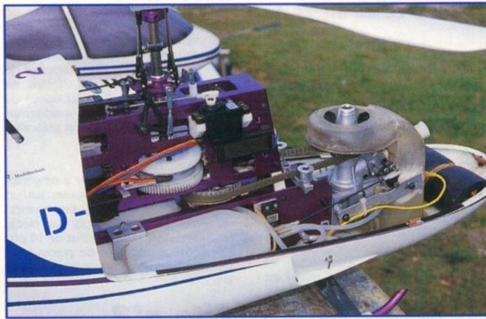
La mécanique Génésis montée dans le fuselage "Défiance" avec l'entraînement classique.
